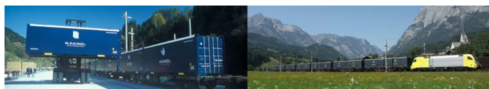
Im Bahnhof Hütttau werden die Container mittels Groß-Stapler vom ECCO-CARGO "Pongau" auf den LKW für den kurzen Nachlauf nach Lungötz gehoben.
