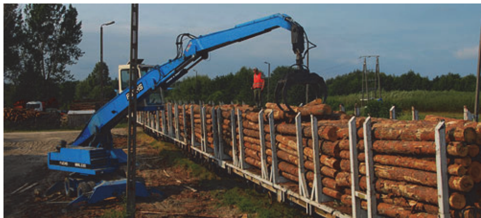
Foto (SETG/G. Pitterka): Beladung von SETG-Snps-XL eines ECCO-SHUTTLE-Ganzzuges mit modernem Umschlagsgerät im ukrainisch/polnischen Grenzterminal Dorohusk
